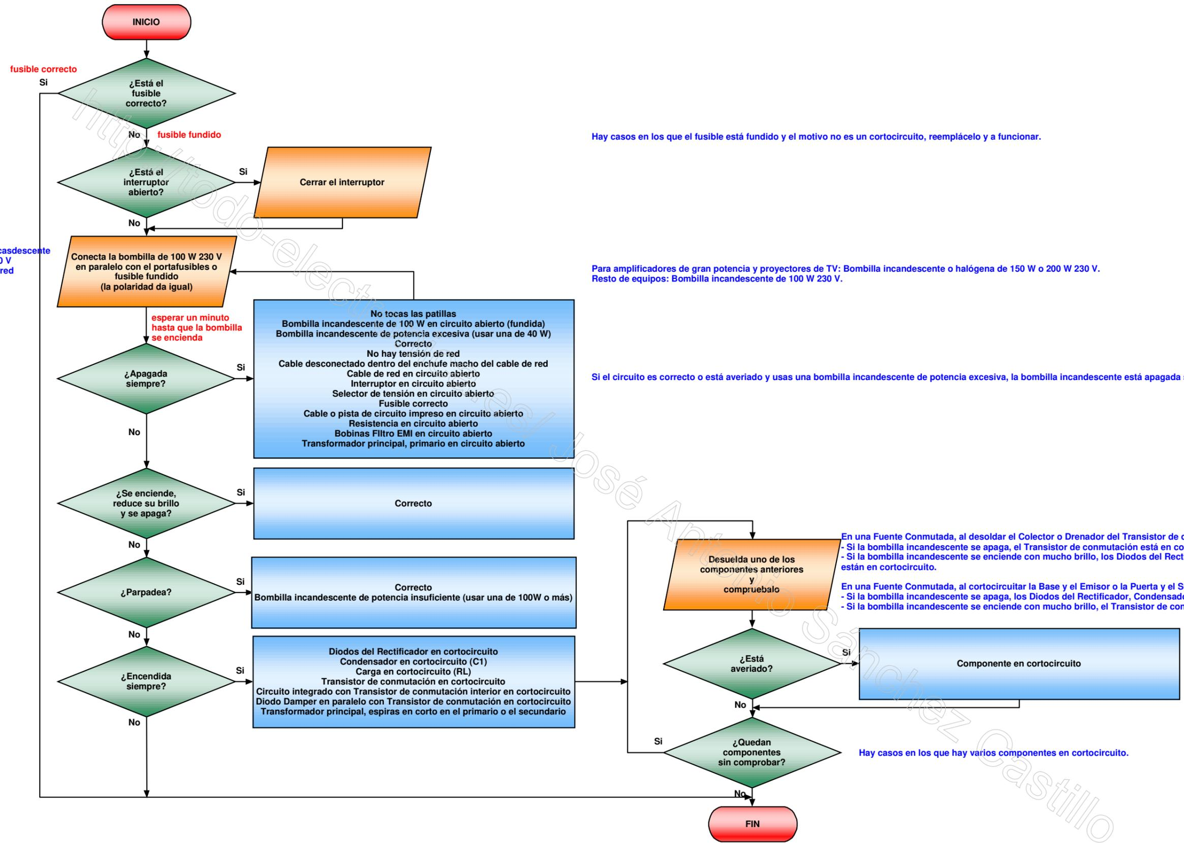
Conecta la bombilla incandescente o halógena de 100 W 230 V en serie con el cable de red y el fusible correcto (la polaridad da igual).
