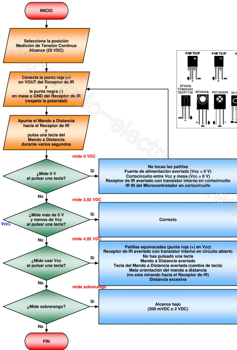
Conecta la punta roja (+) en IR IN del Microcontrolador y la punta negra (-) en masa o GND (respeta la polaridad)
