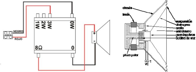
Se oye un chasquido flojo porque el Transformador de 100 V reduce la tensión.
