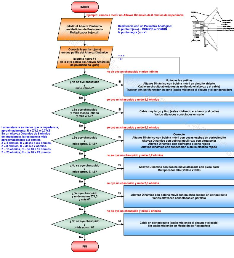
Este procedimiento informa si el altavoz es capaz de convertir la electricidad en sonido. Esta prueba es simple y no puede utilizarse para comprobar la calidad de un altavoz.
