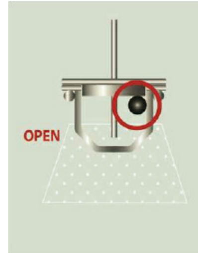
Si se sabotea al aproximarle otro segundo imán externo o tercer imán, el campo magnético del otro segundo imán externo o tercer imán ejerce una fuerza que provoca un movimiento, separándose el imán esférico móvil entre el electrodo y la carcasa metálica y haciendo que el contacto de alarma esté abierto.
