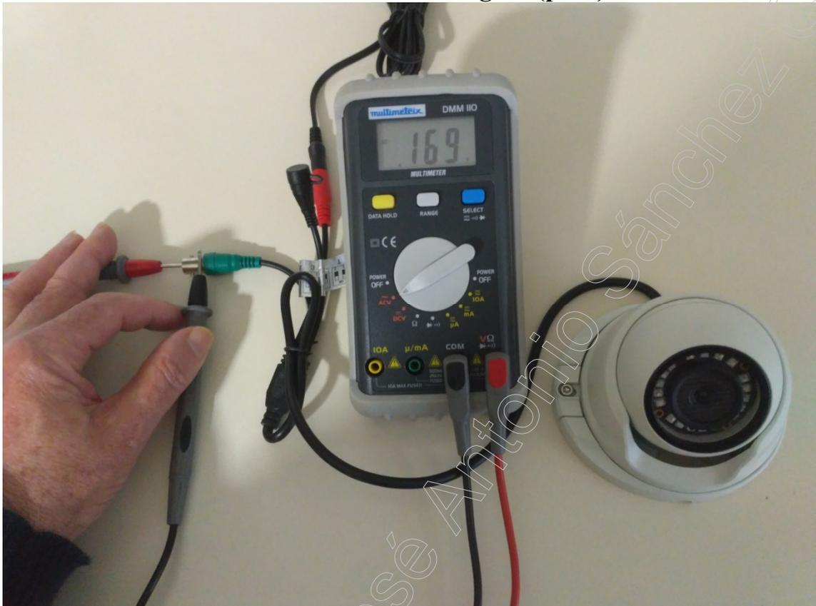
Desconectar el cable de vídeo de la cámara y medir la tensión alterna en el conector BNC hembra de la cámara (comprueba la fuente de alimentación y la cámara):
