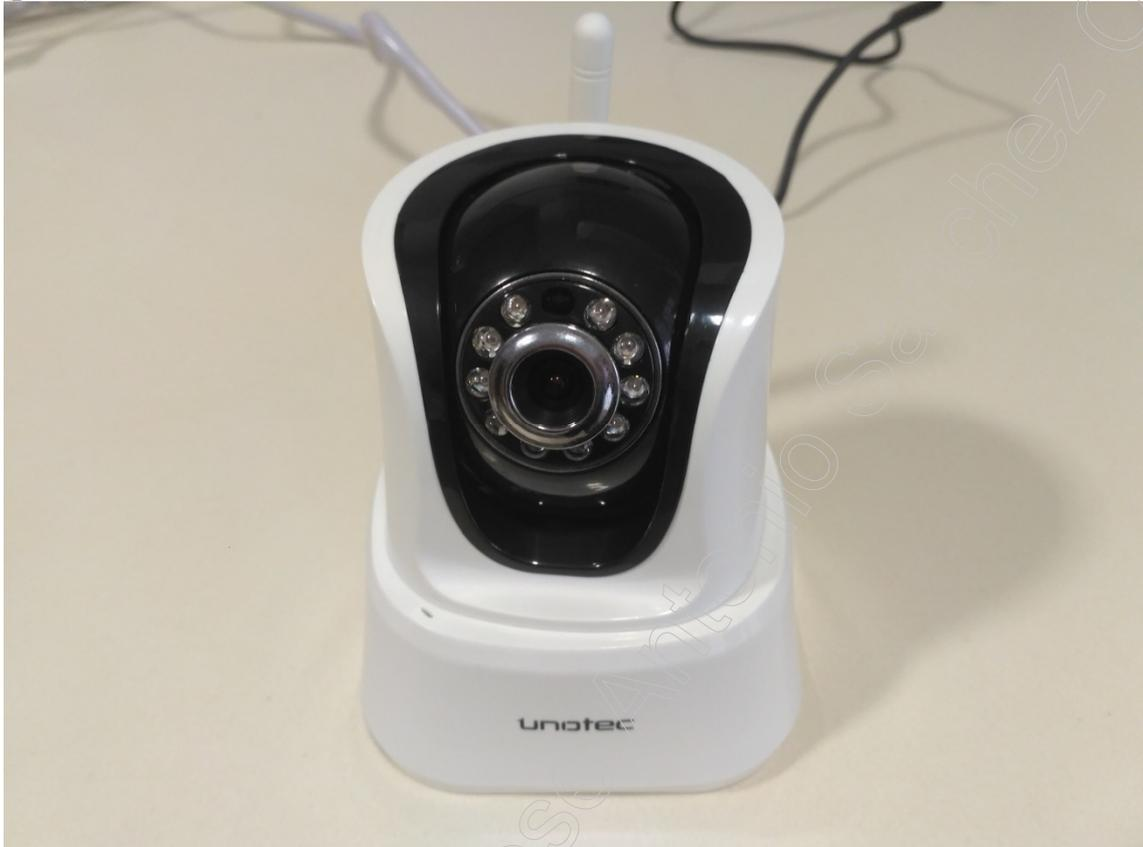
Al alimentar la cámara PTZ debe girar continuamente y oírse un zumbido o ruido cuando está girando (comprueba la fuente de alimentación y la cámara PTZ):
