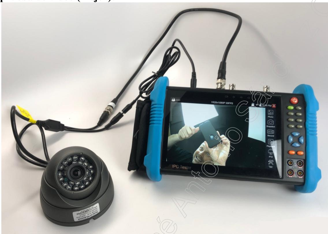
Conectar el conector BNC de la cámara al comprobador o tester para cámaras de vigilancia a través del conector de entrada de vídeo del comprobador o tester para cámaras de vigilancia.
