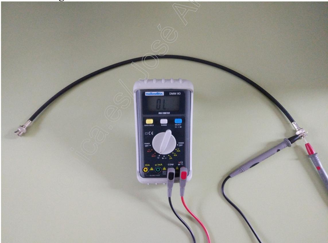
Desconectar los dos extremos, medir en un extremo (comprueba cortocircuito en el cable coaxial o UTP y baluns):
