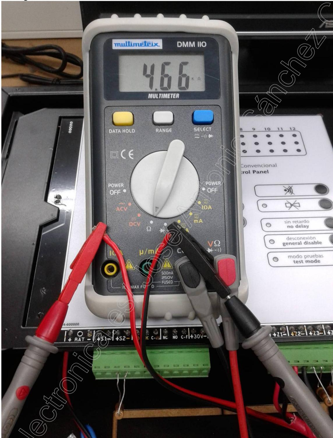
Abrir la central y desconectar el cable de la sirena de la central y medir resistencia en el cable de la sirena.
