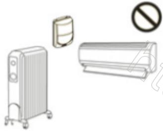
No instale la unidad cerca de un ventilador de salida de un aire acondicionado.
