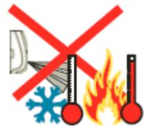
Evite lugares que estén en contacto directo con radiadores, climatizadores, réplicas y conductos de calefacción o refrigeración.
