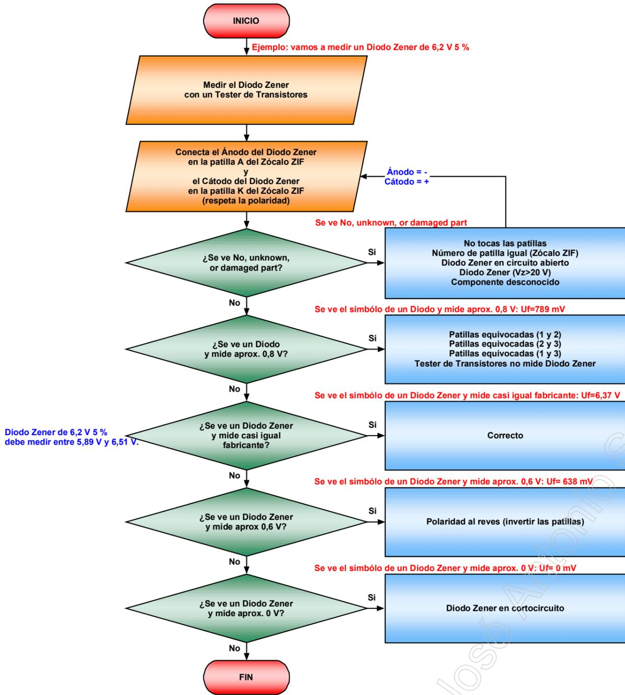
Diodo Zener de 6,2 V 5 % debe medir entre 5,89 V y 6,51 V.
