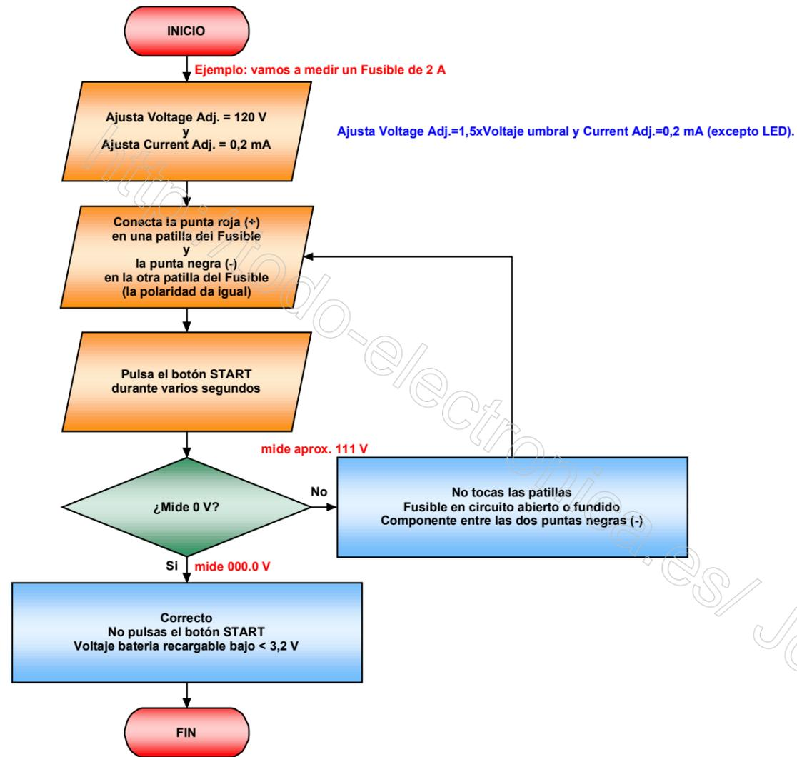
El voltaje del Fusible debe medir 0 V.
