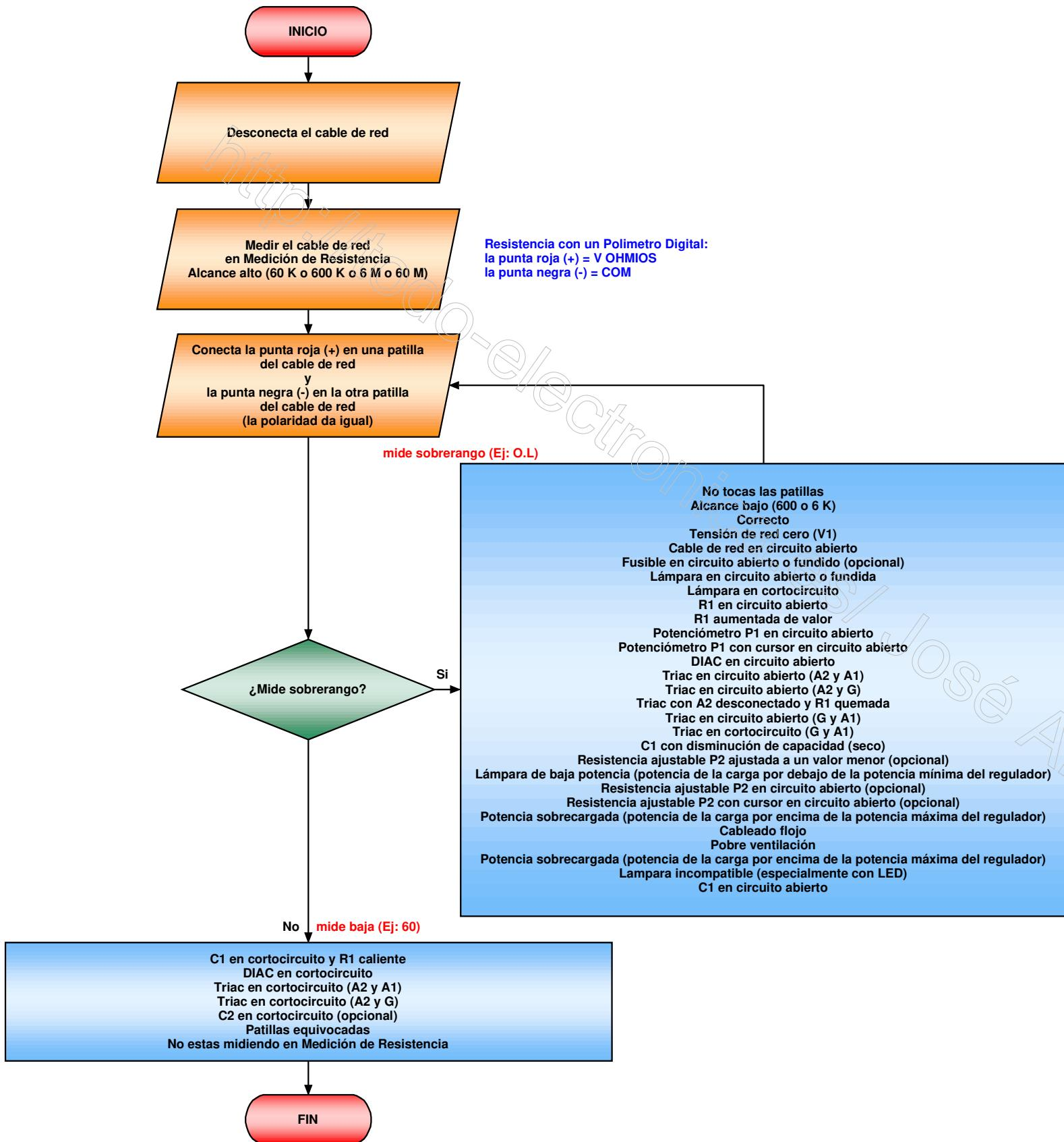
En Medición de Resistencia el sobre rango es indicado por un 1. a la izquierda o por OL (overload).
